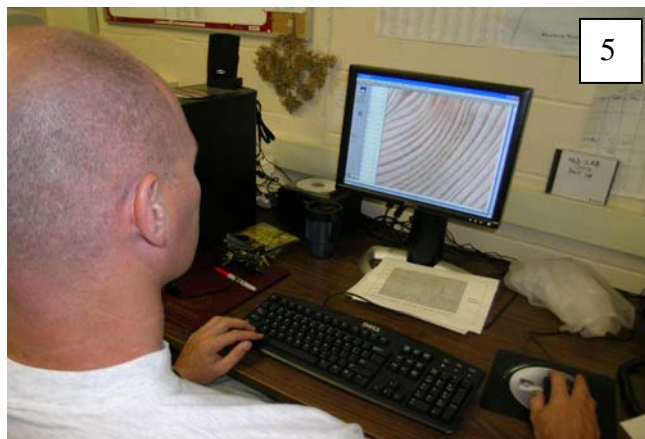
Photo 5 : Mesure de cernes automatisée à l'aide de Windendro©.
